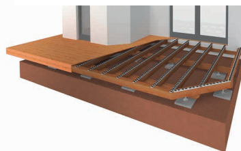
Auf instabilem Boden (nicht verdichteter Boden)
